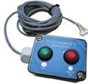
Mit der Abfahrtskontrolle können Fahrer vor Antritt der Fahrt durch die Betätigung eines grünen oder roten Druckknopfes den Zustand des Flurförderzeuges im Logbuch der Mobile Easykey Software protokollieren: „Fahrzeug ok“ oder „Fahrzeug nicht ok“.
