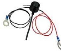
Der Sensor für Einbau- und Wechselbatterien wird zur Kontrolle des Elektrolytstandes der Batterie eingesetzt. Bei zu geringem Elektrolytstand wird eine „Achtungs-Anzeige“ am Modul geschaltet (modular, smart lock 3: LED; modular plus: Display Anzeige). Gleichzeitig erfolgt eine Eintragung ins Logbuch der Software.
