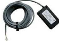
Die Radar-Anwesenheitserkennung dient zur sicheren Detektion der Anwesenheit eines Fahrers und der automatischen Abschaltung des Flurförderzeugs beim Verlassen und damit auch zur Energieeinsparung. Sie kommt zum Einsatz, wenn das Fahrzeug selbst keine Sensoren (z. B. Sitzkontaktschalter) zur Erkennung hat oder man nicht in die Fahrzeugelektronik eingreifen will. Mit dieser Anwesenheitserkennung können auch Nutzungsstunden dargestellt werden. Der Plug & Play-Aufbau ist in wenigen Minuten möglich.
