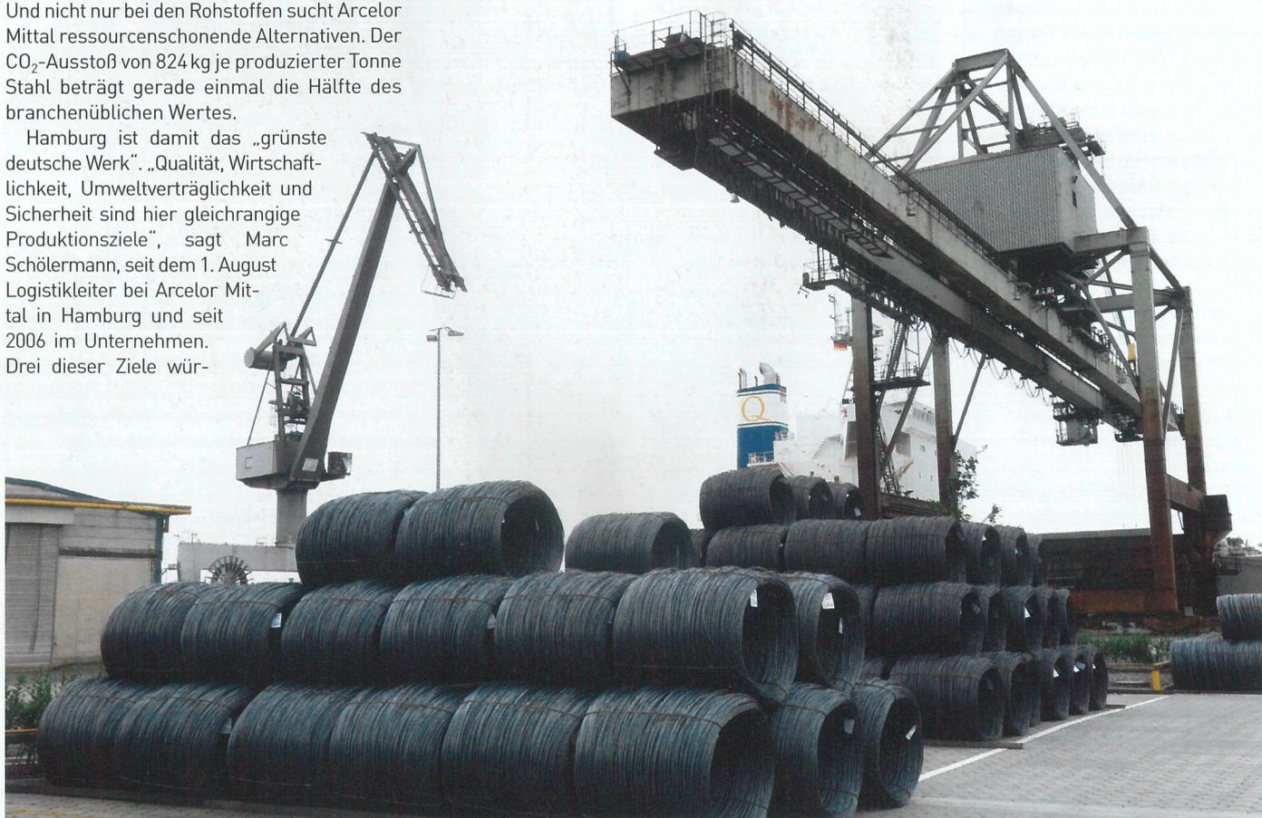
1 Im Hamburger Werk werden überwiegend Drähte hergestellt, aus denen in der Weiterverarbeitung bei Kunden Baustähle, Spannstähle für Brückenseile, Reifen- und Schweißdrähte oder auch Angelhaken entstehen.
