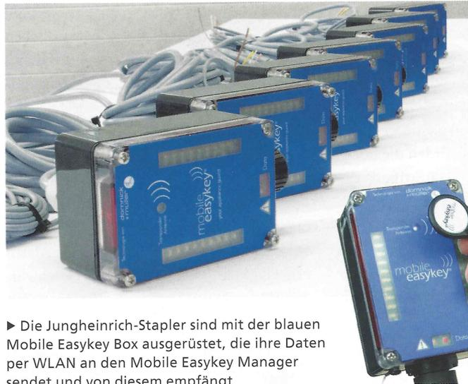
► Die Jungheinrich-Stapler sind mit der blauen Mobile Easykey Box ausgerüstet, die ihre Daten per WLAN an den Mobile Easykey Manager sendet und von diesem empfängt
